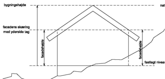
Figur 3: Måling af facade- og bygningshøjder sker fra fastlagt niveauplan for bebyggelser på skrånende terræn eller terræn med større niveau forskelle.
